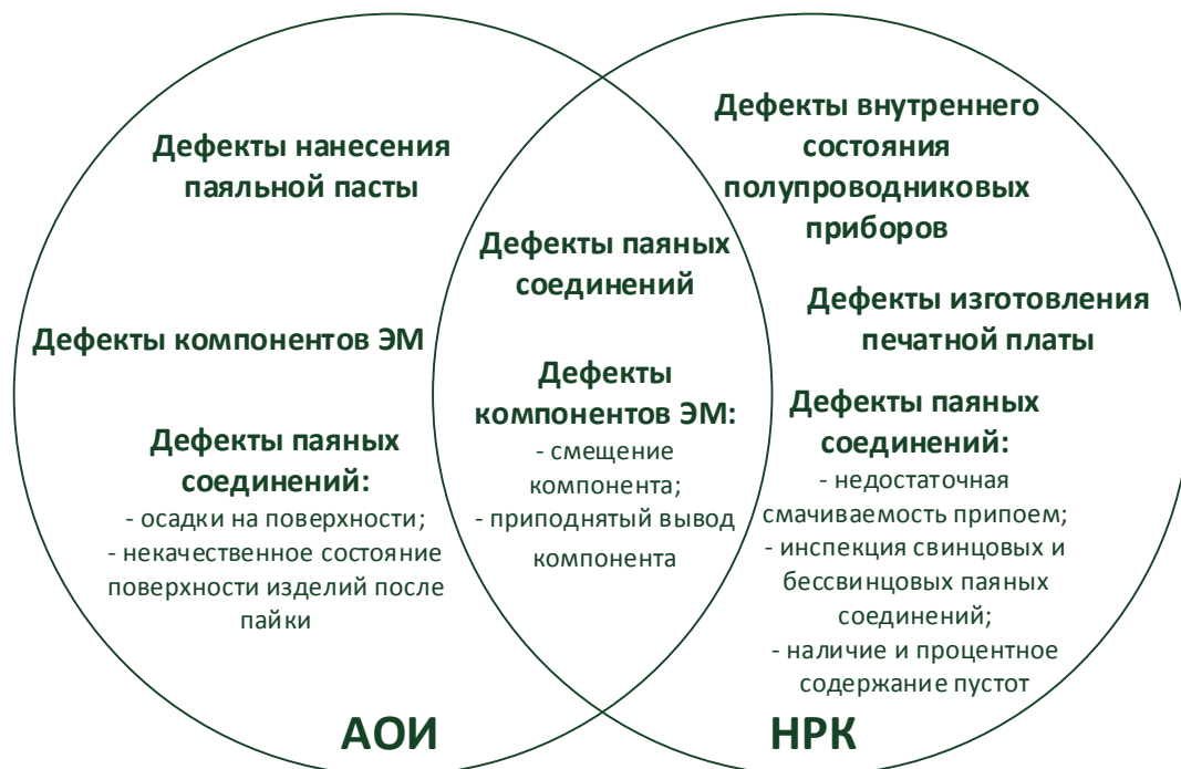
Рис. 2. Эффективность совместного применения АОИ и НРК для обнаружения дефектов Fig. 2. The efficiency of combined use of AOI and AXI for the defect detection
