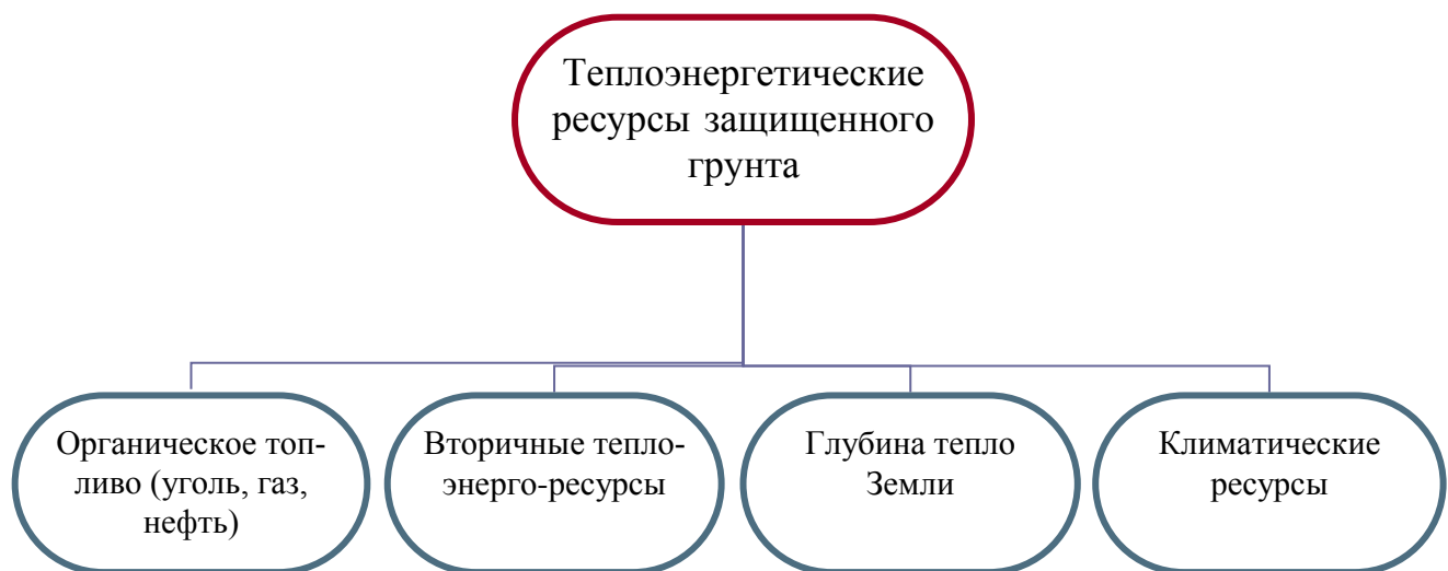
Рис. 1. Энергетические ресурсы защищенного грунта
